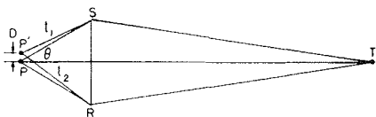
Fig. 27-9. Pouvoir de résolution d'un système optique.
